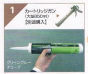
カートリッジガン(大型)に チューブをセットします。
